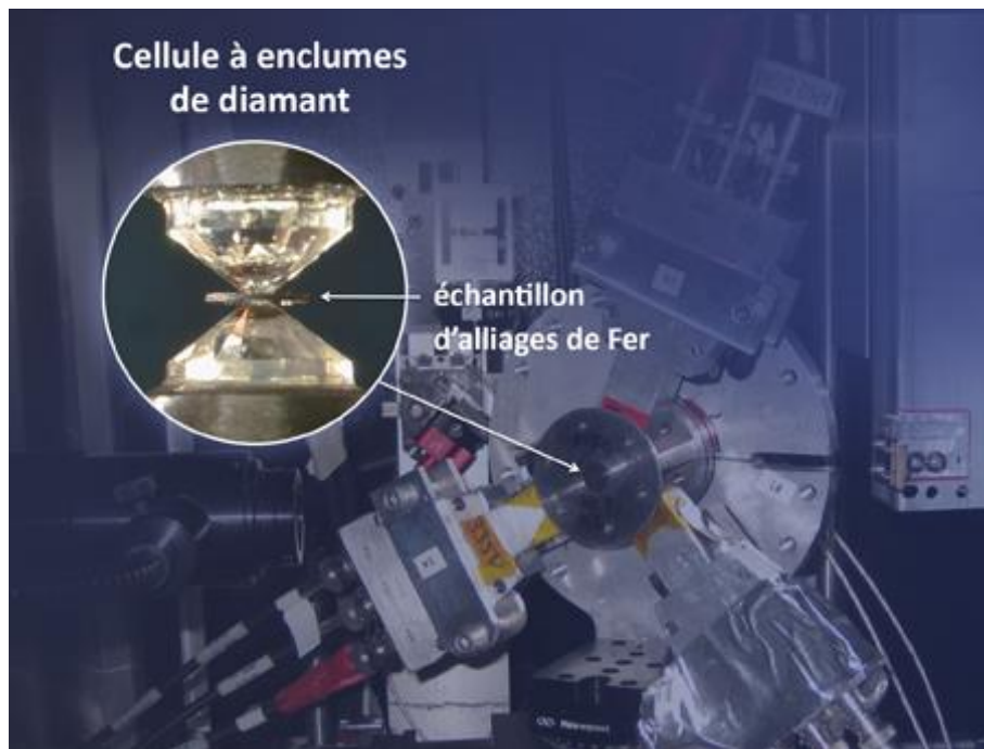
Cellule à enclume de diamant permettant d'atteindre des pressions régnant au centre de la Terre (© S. Merkel), installée sur le dispositif de mesure sur le synchrotron APS, Chicago, USA (© J.F. Lin).
